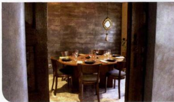
Nella foto a destra uno scorcio della sala da pranzo dove non ci sono termosifoni. A riscaldare la stanza ci pensa la parete in ceramica esposta a Ovest, che raccogliendo il calore del sole lo rilascia poi gradualmente.
